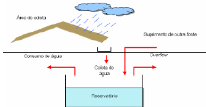
Figura 2- Esquema de aproveitamento de água de chuva
