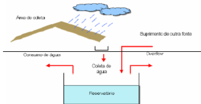
Figura 2- Esquema de aproveitamento de água de chuva
