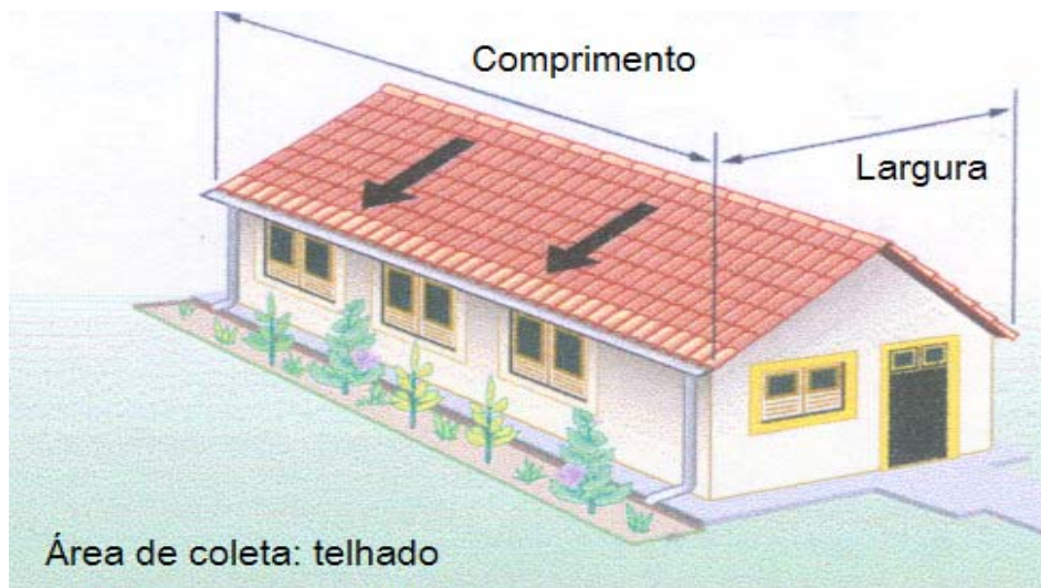
Figura 3.1 Área de coleta: telhado = comprimento x largura
