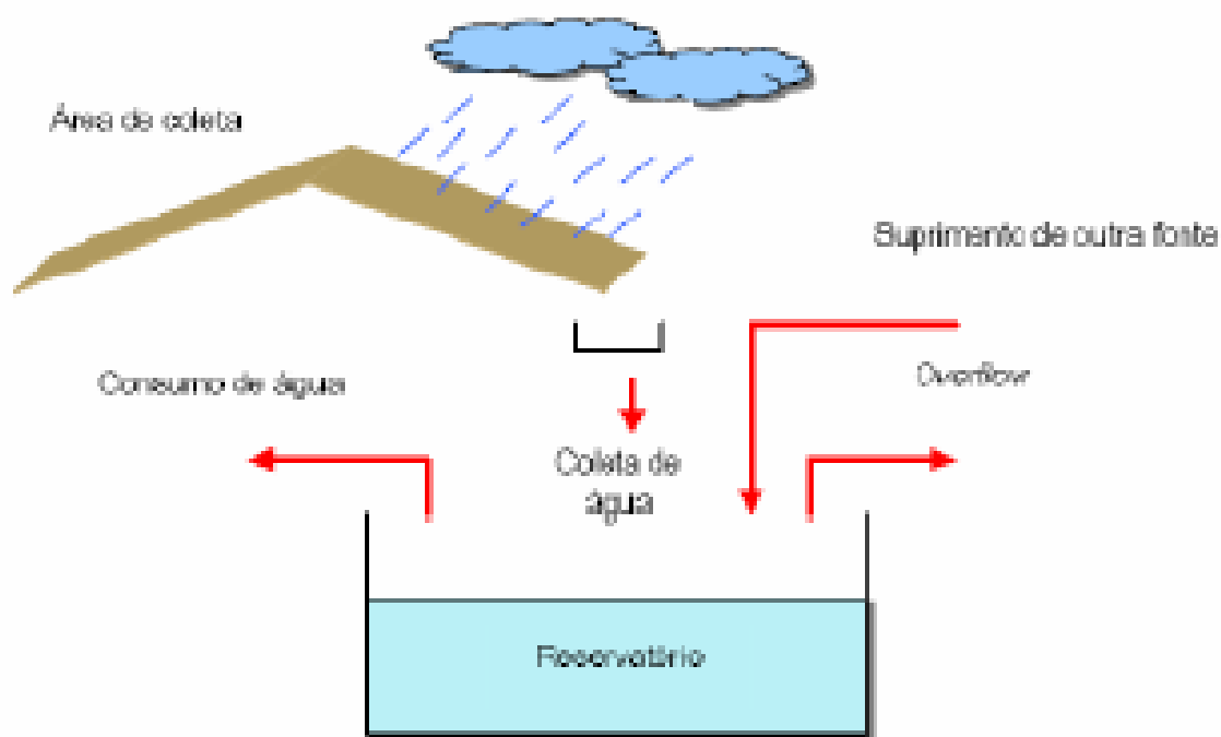
Figura 2.1 Esquema de aproveitamento de água de chuva
