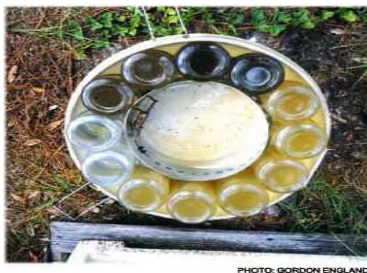
Figura 2.7 Amostradores de qualidade da água de chuva. Início da precipitação com a garrafa marrom (posição do relógio a 45min)
