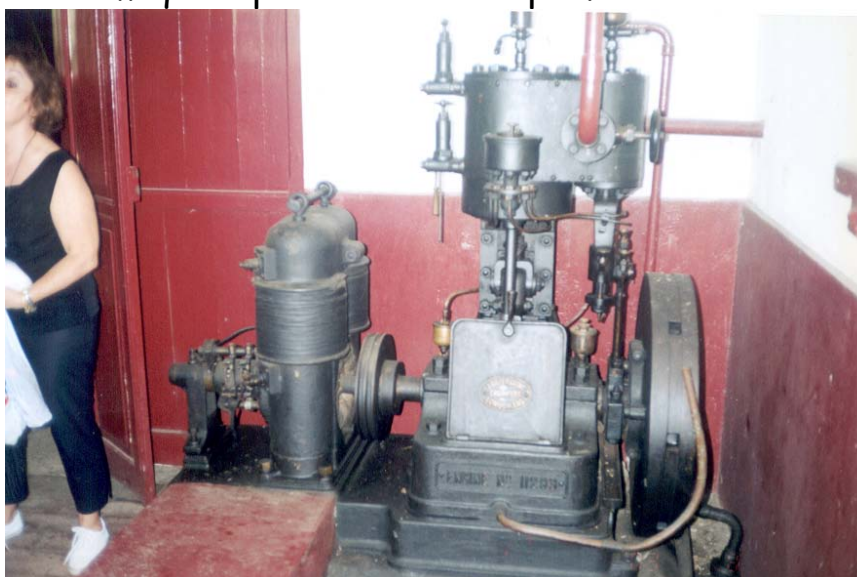
Foto tirada pelo engenheiro Plínio Tomaz em 2002, da máquina que gerava eletricidade proveniente de tubulação de vapor, para funcionamento de telefone.
