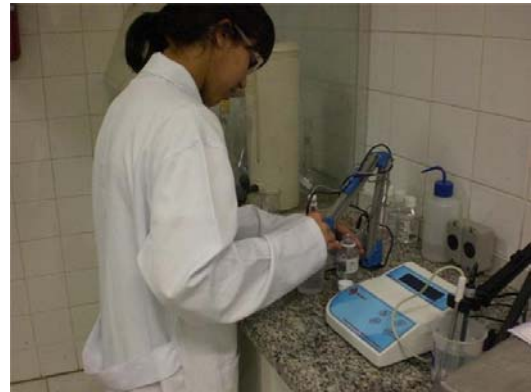
Fig.09 – Testes de pH em pHmetro digital.
