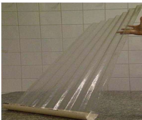
Fig.06 – Coletor da água da chuva utilizada nas coletas.
