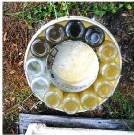
Figura 13.1 - Amostradores de qualidade da água pluviais. Início da precipitação com a garrafa marrom (posição do relógio a 45min). Fonte: TUCCI, (2001)
