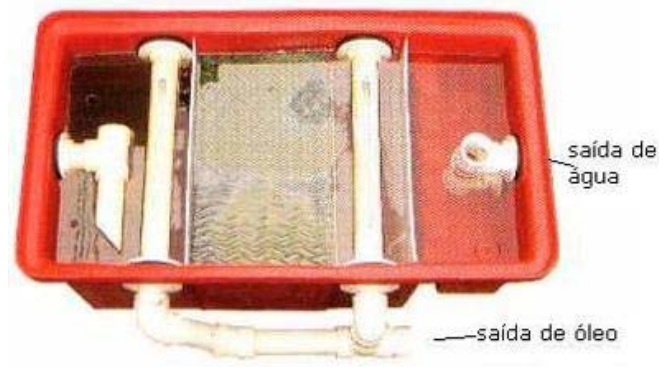
Figura 36.17 – Caixa separadora de óleo fabricado http://www.capeonline.com.br/com_sep.htm . Acesso em 17 de julho de 2008 de 10\text{m}^3/\text{h} a 40\text{m}^3/\text{h} com teor máximo de saída de óleo de 20\text{mg/L} .
