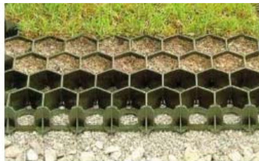
Figura 60.6- Pavimento poroso com grama reforçada que permite que a água passe pela zona das raízes e vá até o solo ficando uma superfície resistente inclusive para passagem de veículos. Fonte: http://www.flowstobay.org/
