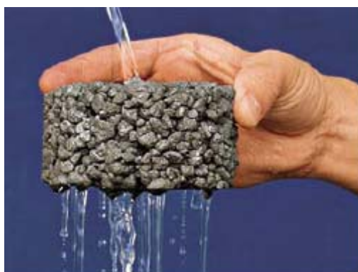
Figura 60.1- Concreto poroso permite que a água passa pelos espaços entre os poros do agregado. Fonte: http://www.flowstobay.org/
