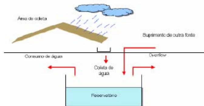
Figura 3.2- Esquema de aproveitamento de água de chuva
