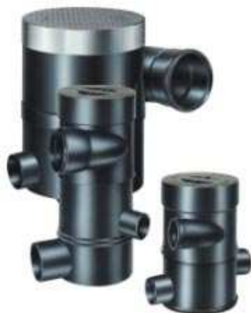
Figura 7.9- Dispositivo automático para autolimpeza da água de chuva com peneiras Vortex da Aquastock para área de 200m 2 , 500m 2 e 3000m 3 .
