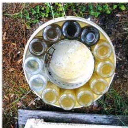
Figura 19.2 - Amostradores de qualidade da água pluviais. Início da precipitação com a garrafa marrom (posição do relógio a 45min). Fonte: TUCCI, (2001)
