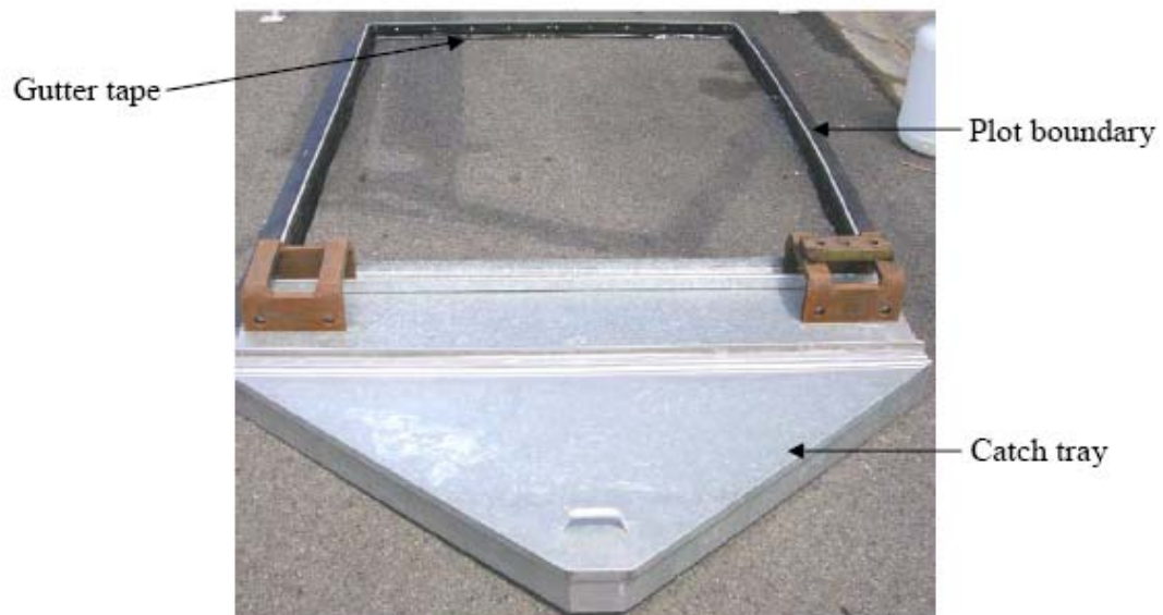
Figura 27.7- Coleta do runoff da chuva artificial
