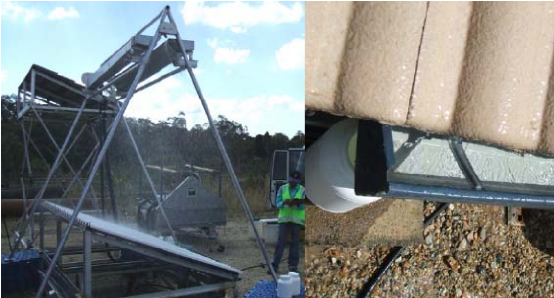
Figura 27.5- Simulação de chuva em telhado
