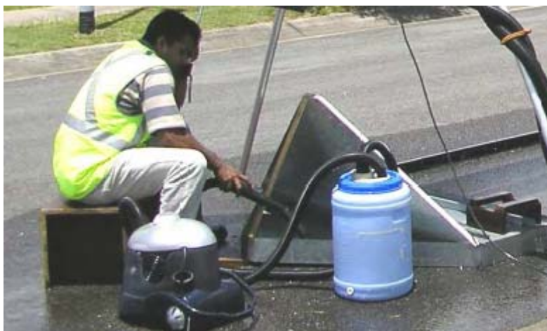
Figura 27.8- Coleta do runoff em vasilhame de polietileno
