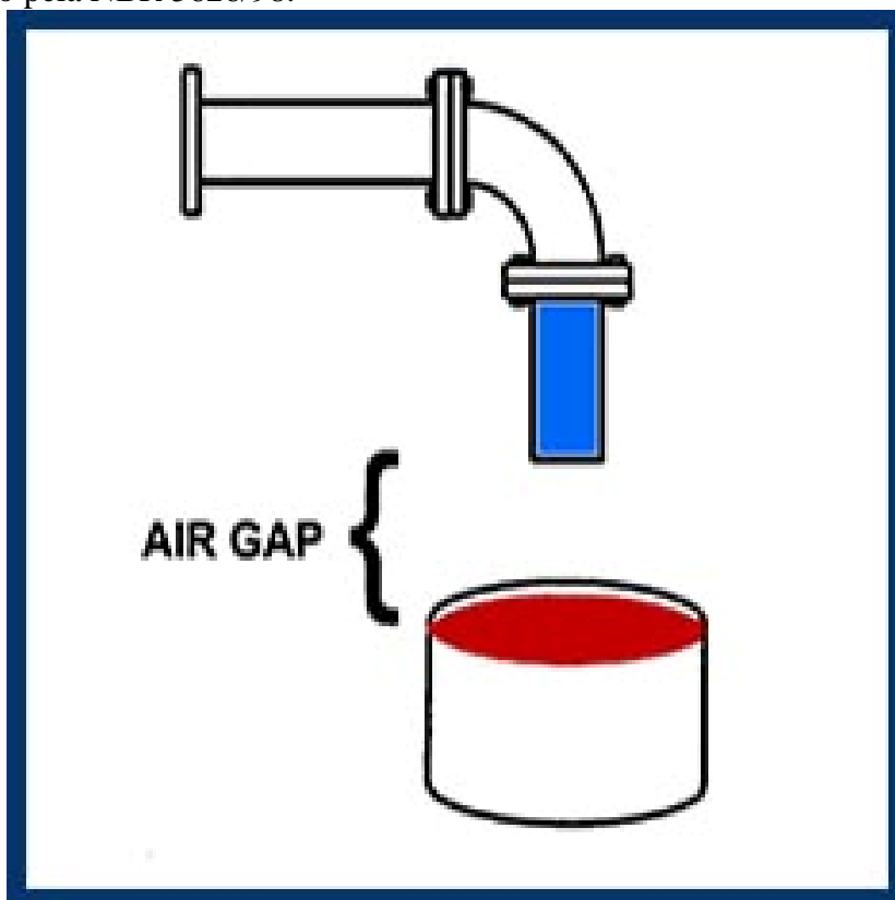
Figura 25.7- Air gap (separação atmosférica)
