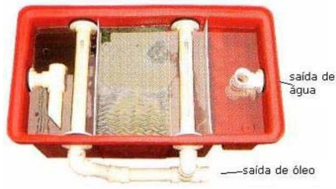
Figura 14.17 – Caixa separadora de óleo fabricado http://www.capeonline.com.br/com_sep.htm . Acesso em 17 de julho de 2008 de 10m 3 /h a 40m 3 /h com teor máximo de saída de óleo de 20mg/L.
