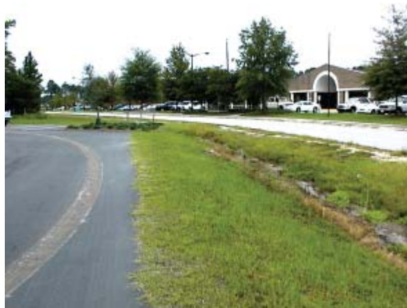
Figura 20.4 - Faixa de filtro gramada ao longo de uma estrada. Fonte: http://crd.dnr.state.ga.us/assets/documents/GGG3C.pdf
